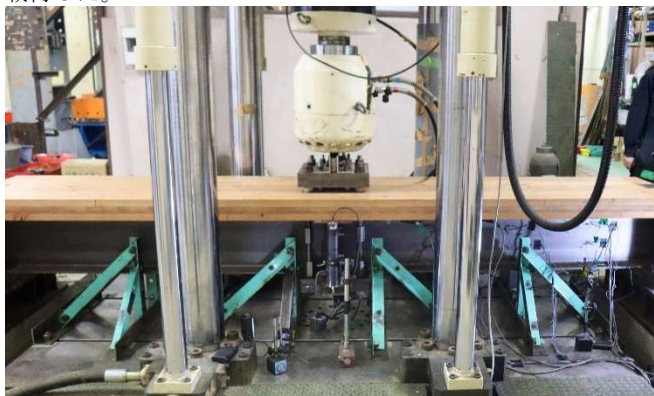
図1. 試験体と三点載荷装置
